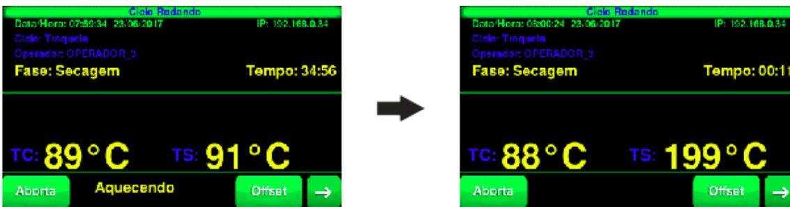
A fase de secagem inicia a partir do momento que a temperatura de secagem é atingida, o tempo máximo para atingir essa temperatura é de 35 minutos. Atingida a temperatura a fase de secagem inicia, nessa fase o um ventilador é ligado para secar o material que foi esterilizado.
