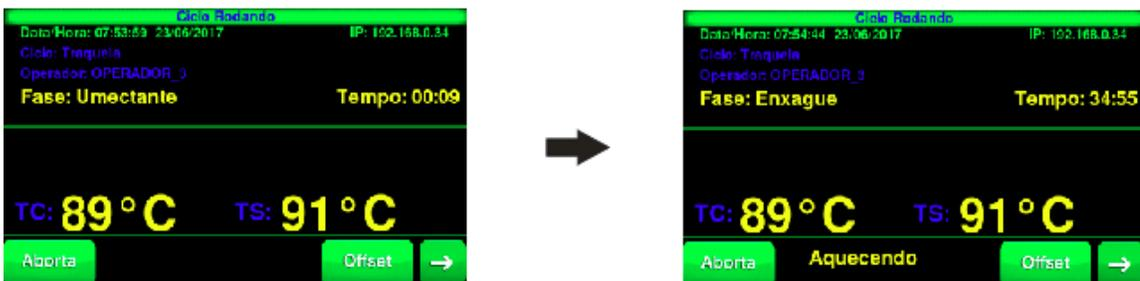
Para a fase Umectante, é inserido na cuba uma solução umectante para preparar a água para a próxima fase de Enxague.
