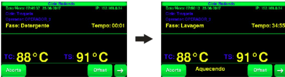
Para a fase Detergente, é inserido na cuba uma solução detergente para preparar a água para a próxima fase de Lavagem.
