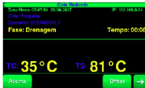
Durante a Pré-Lavagem não há aquecimento, a Termodesinfectora realiza uma lavagem rápida a frio e depois faz a Drenagem.
