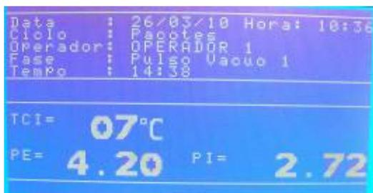
Indicando que estamos no ciclo de Pré Vácuo e também a temperatura e pressão da câmara interna naquele momento. Durante todo o ciclo teremos no display a indicação da temperatura e pressão da câmara externa e interna, bem como se o equipamento esta aplicando pressão ou vácuo a câmara interna.
